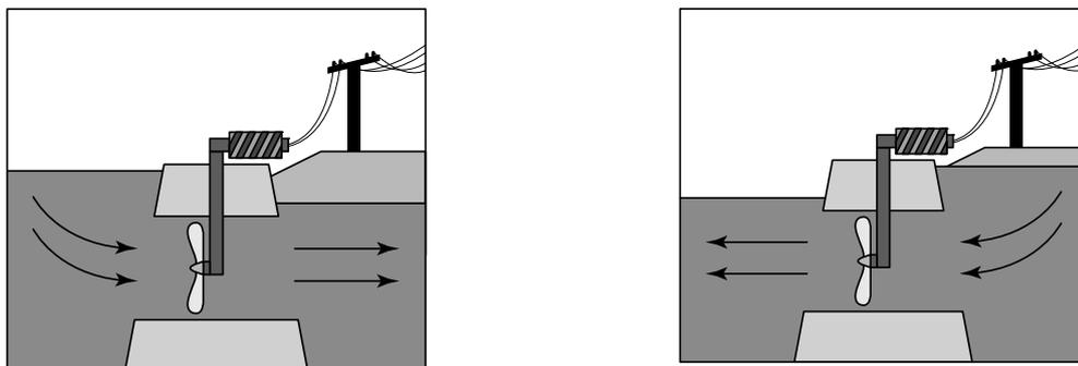
Met het stromende water wordt elektrische energie opgewekt.
